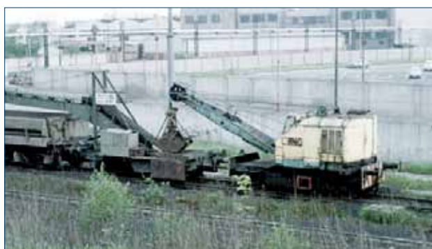
Drapákový nakladač, upravený v SHR z plazového na podvozek T 211.0, DVIL Záluží
